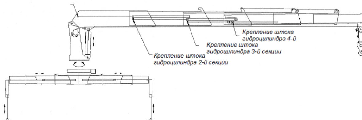
Рис. 6 КМУ модели SS1966 ACE. Схема кинематическая.
